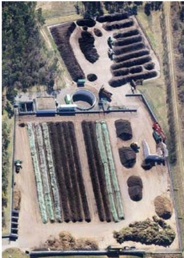
Auf über 90 Meter langen Zeilen wird der Biomüll mit frisch gehäckseltem Grünschnitt vermisch und dann unter freiem Himmel der Arbeit von Mikroorganismen überlassen. Diese „fressen“ Organisches auf, töten mögliche Krankheitserreger ab und erzeugen dabei wertvollen Humus. Die Zeilen werden jede Woche
